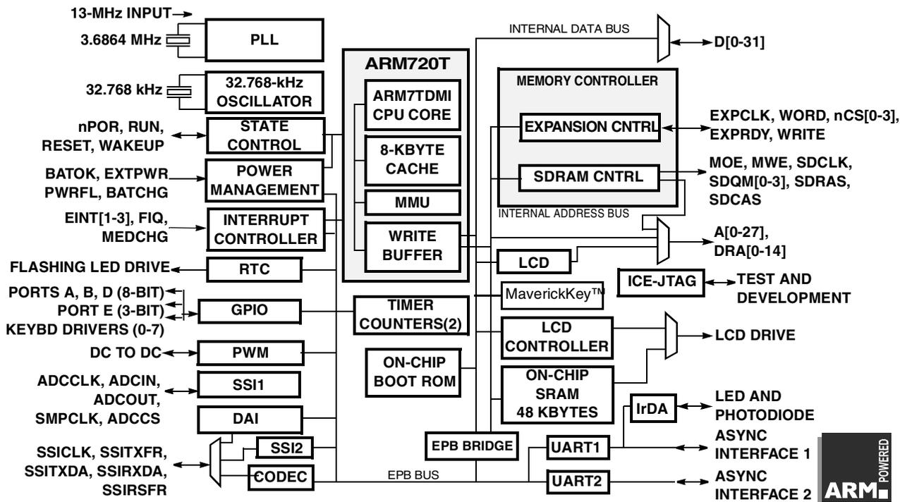
Figure 1-1. EP73xx Block Diagram
